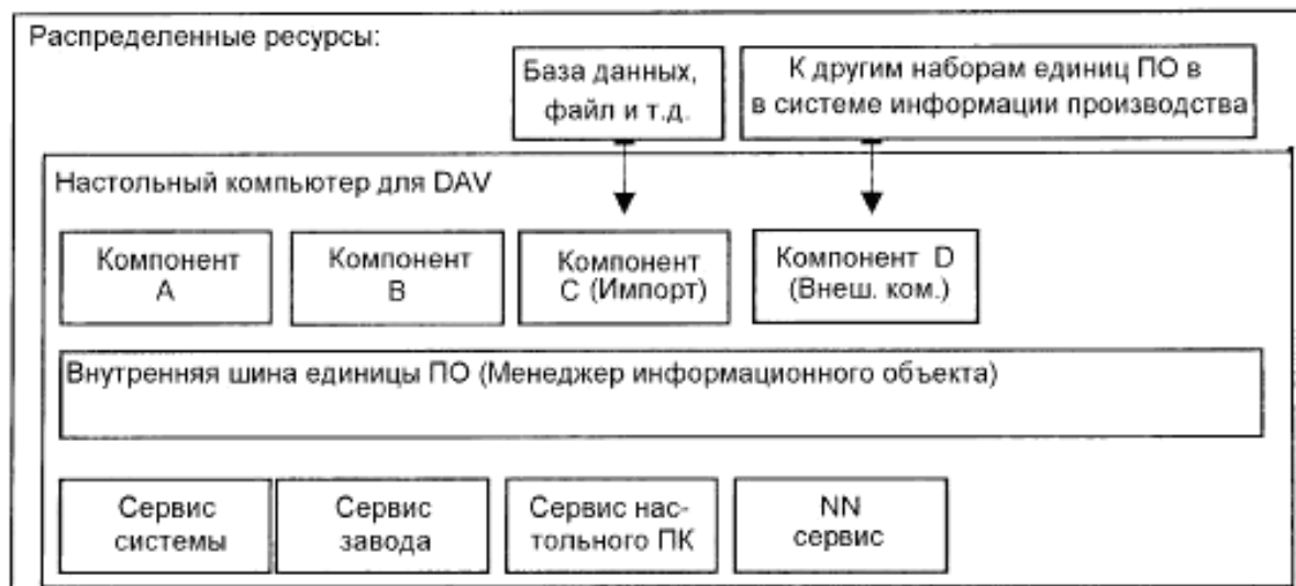
Рисунок С.1 – Структура единицы программного обеспечения DAV на основе компонента
