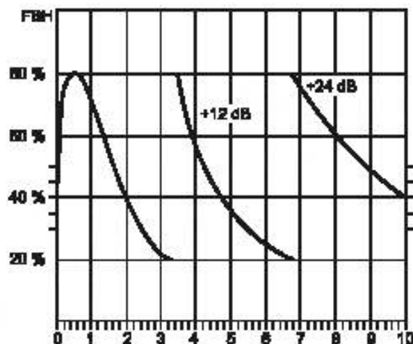
Рисунок 9 — Экран ультразвукового прибора, показывающего разделение DAC-кривой
