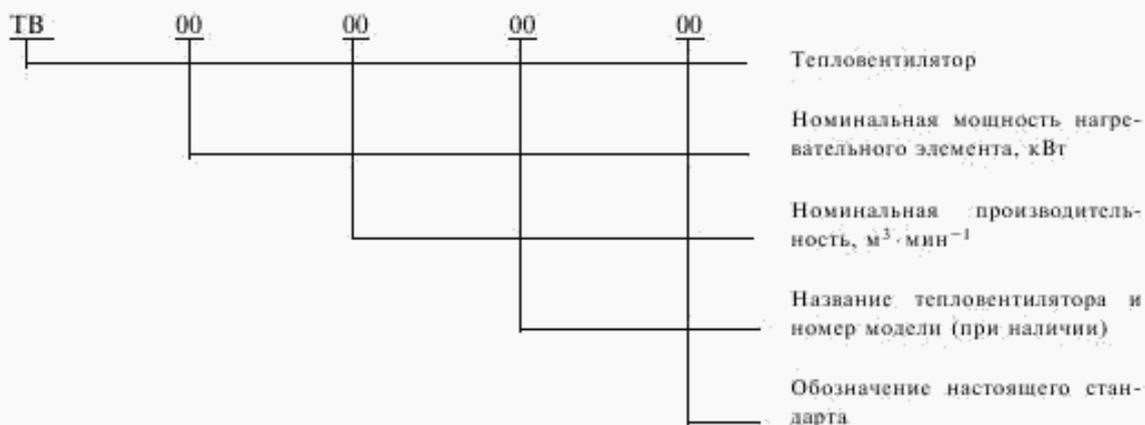
Пример условного обозначения тепловентилятора с номинальной мощностью нагревательного элемента 1,25 кВт, номинальной производительностью  $1,6 \text{ м}^3 \cdot \text{мин}^{-1}$ , с названием «Хевел» и номером модели 4:
