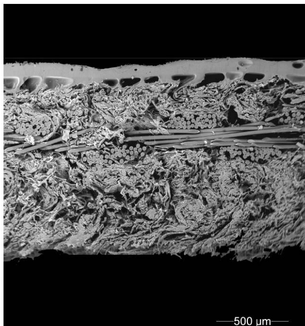
Рисунок А.11 — Сечение текстильного материала, покрытого коженными волокнами
