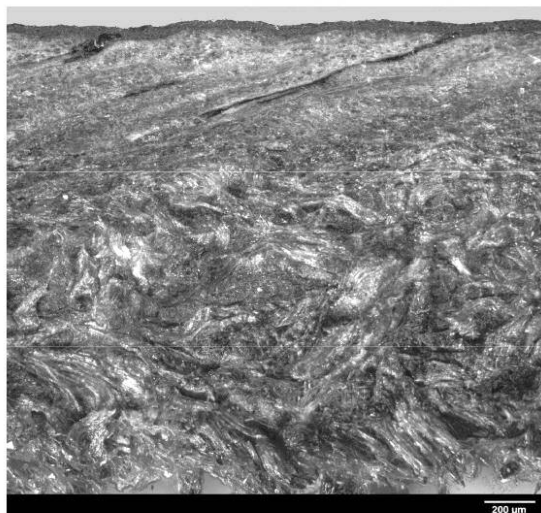
Рисунок В.1 — Типичное сечение кожи, выработанной из шкуры крупного рогатого скота (КРС) с лицевым покрытием менее 150 мкм
