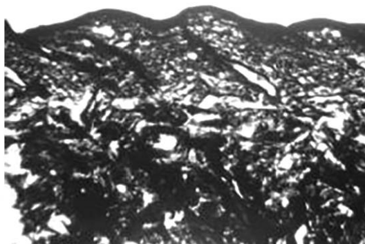
Рисунок С.1 — Фотография сечения темной кожи, полученная с помощью фазово-контрастного оптического микроскопа
