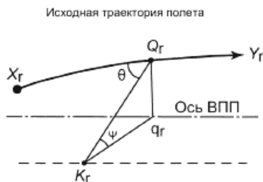
Рисунок 4 — Участки измеренной и исходной траекторий полета на оси ВПП
