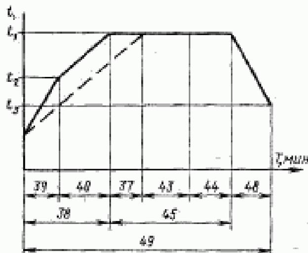
$t_1$ —температура стерилизации, °С;  $t_2$ —точка кипения воды при атмосферном давлении, °С;  $t_3$ —температура охлаждения, °С; — — изменение температуры в точках полезного объема наиболее труднодоступных для стерилизующего агента.
