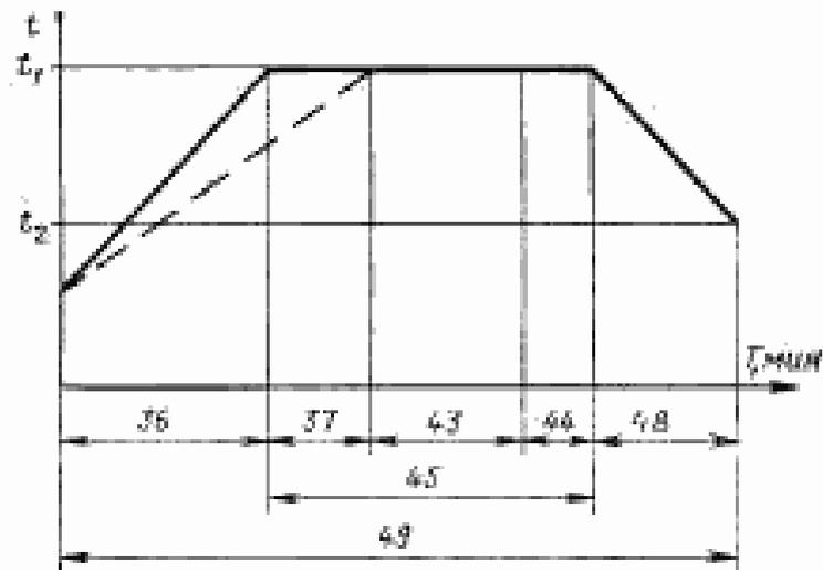
$t_1$ —температура стерилизации, °С;  $t_2$ —температура охлаждения, °С; — — — изменение температуры в точках волевого объема наиболее труднодоступным для стерилизующего агента
