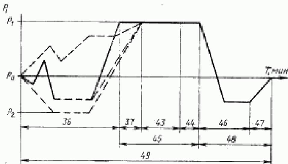
$P_0$  — атмосферное давление, Па;  $P_1$  — давление пара при температуре стерилизации, Па;  $P_2$  — вакуум по заданной программе, Па; — — — — — значения давления в точках полезного объема наиболее труднодоступных для стерилизующего агента
