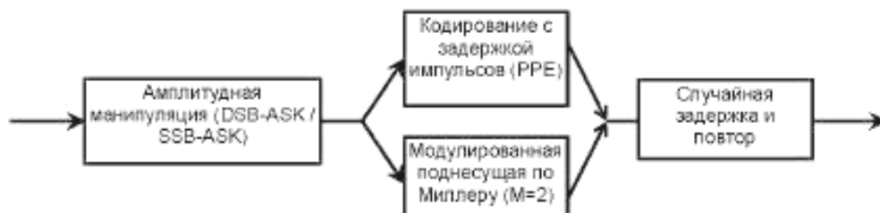
Рисунок 8 — Структура радиочастотной метки типа D
