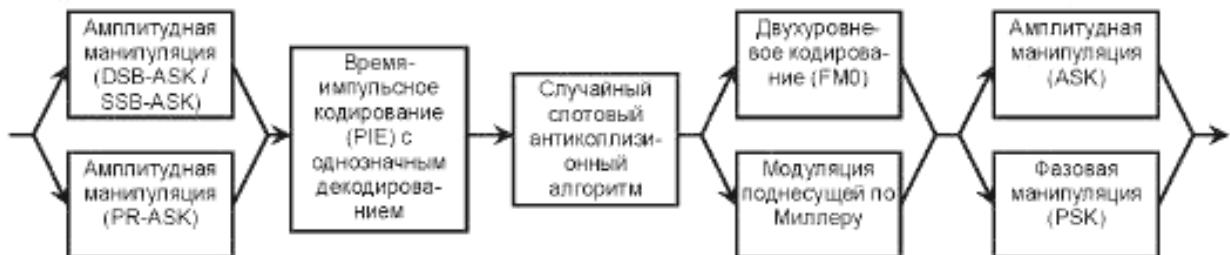
Рисунок 7 — Структура радиочастотной метки типа С
