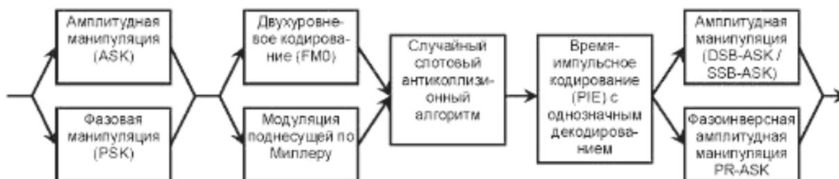
Рисунок 3 — Структура устройства опроса типа С
