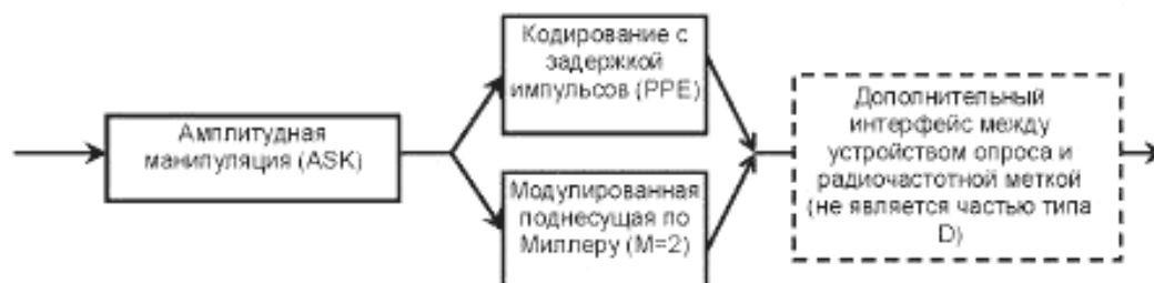
Рисунок 4 — Структура устройства опроса типа D
