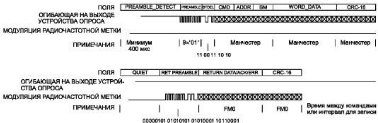
Рисунок 12 — Пример пакетов команды GROUP_SELECT и ответа на команду (при скорости передачи данных по прямой и обратной линиям связи 40 Кбит/с)
