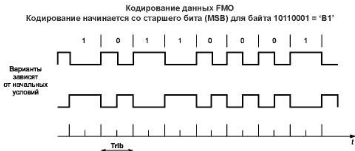
Рисунок 4 — Кодирование данных в обратной линии связи «радиочастотная метка — устройство опроса»
