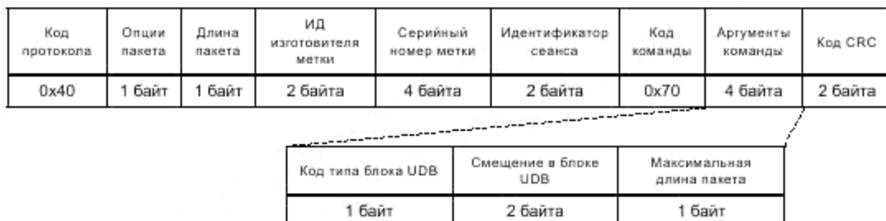
Рисунок 10 — Частная команда USO конкретной радиочастотной метке для получения оставшейся части данных блока UDB
