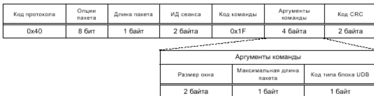
Рисунок 8 — Общая команда «Collection with UDB» для начального опроса радиочастотных меток
