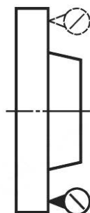
Рисунок 13 — Схема измерения торцового биения фланца шпинделя передней бабки с помощью средства измерений линейных размеров
