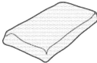
а) Раскладывают измельченную пробу слоем в форме прямоугольника с максимальной толщиной, равной трем максимальным размерам кусков топлива
