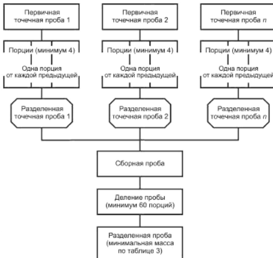
а) Пример деления отдельных точечных проб (на минимальное число порций)
