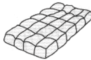
б) Расчерчивают топливо при помощи шаблона на 20 равных частей, например пять равных частей по длине и четыре равные части по ширине
