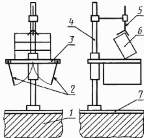
1 — фундамент; 2 — створки; 3 — рама; 4 — стойка; 5 — фиксатор; 6 — испытываемый образец; 7 — стальная плита
