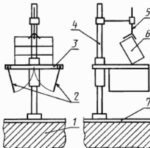
1 — фундамент; 2 — створки; 3 — рама; 4 — стойка; 5 — фиксатор; 6 — испытываемый образец; 7 — стальная плита
