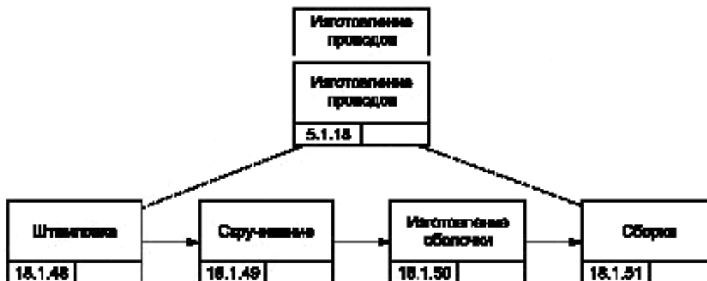
Рисунок С.6 — Процесс изготовления проводов 350-Wire
