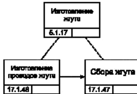
Рисунок С.4 — Процесс изготовления жгута 350-Harness
