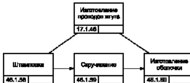
Рисунок С.5 — Процесс изготовления проводов жгута
