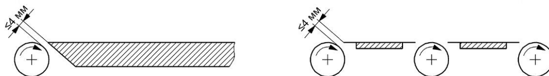
Рисунок 4 — Пример защиты роликового конвейера
