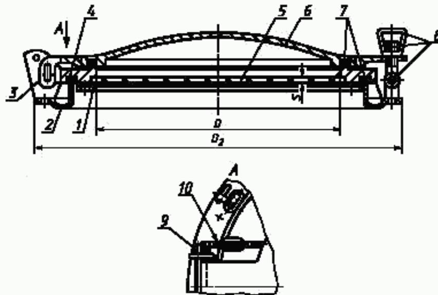
1 — кольцо на винтах для крепления стекла; 2 — корпус; 3 — петля; 4 — рама; 5 — стекло; 6 — штормовая крышка; 7 — уплотнительная прокладка;  $B$  — задрайка (откидной болт, гайка-барашек, ось); 9 — закладной штырь; 10 — цепочка
