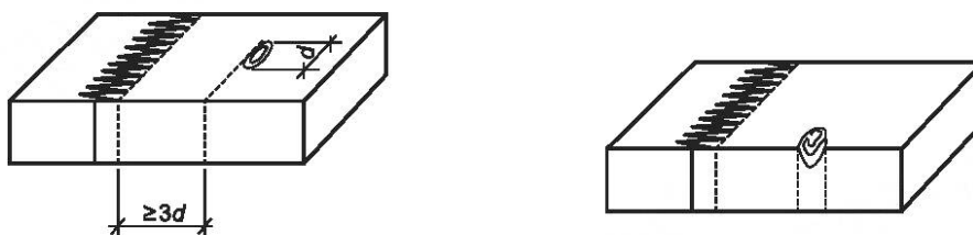
Рисунок 3 — Минимальное расстояние от сучка до основания зубчатого шипа
