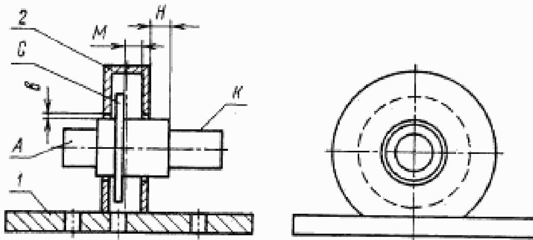
1—нижняя плита измерительной панели с отверстиями для контактов, обеспечивающих подключение лампы к измерительной установке; 2—экран с отверстиями; А, С, К—контактные поверхности выводов электродов испытываемой лампы.
