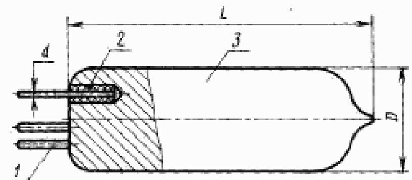
1—выводы модели лампы; 2—изолирующие прокладки; 3—корпус модели лампы
