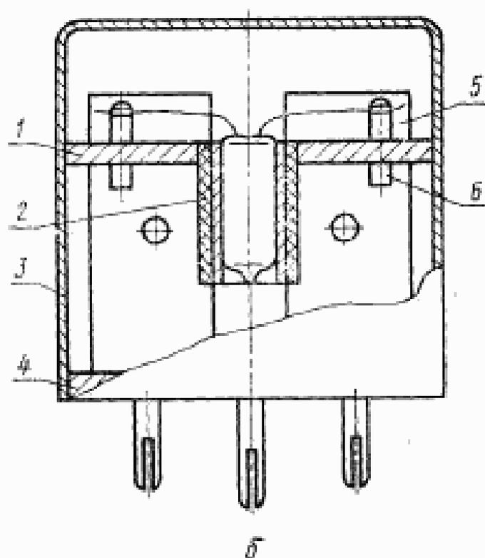
1—лицевая плата измерительной панели; 2—приспособление для крепления и ориентации испытываемой лампы; 3—общий экран для защиты от воздействия внешних электрических полей; 4—основание панели с контактными штырьками для подключения к измерительной установке; 5—разделительные экраны для устранения взаимного влияния выводов лампы и контактных устройств панели; 6—контактные устройства (лепестки) для подключения выводов испытываемой лампы.
