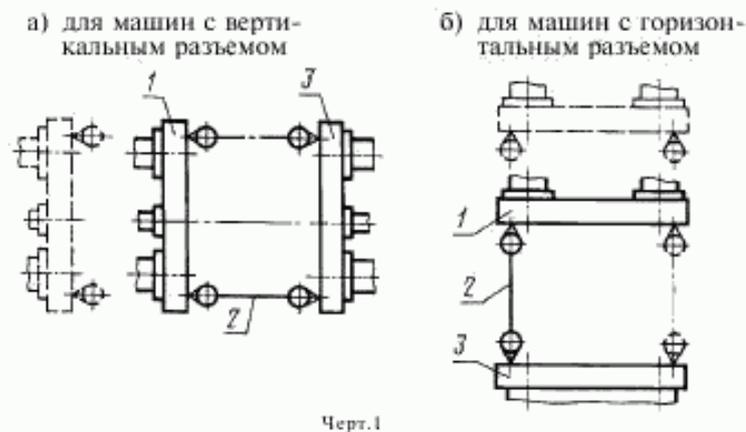
Допуск параллельности — 0,4 мм на 1 м длины.
