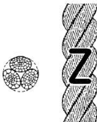
Рисунок 1- Конфигурация 3-рядного крученого каната (тип А)
