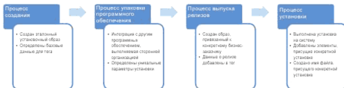
Рисунок А.1 – Жизненный цикл тега идентификации программного обеспечения
