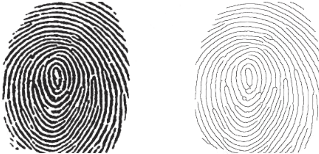
Рисунок F.8 — Бинарное изображение и остов гребней [17]
