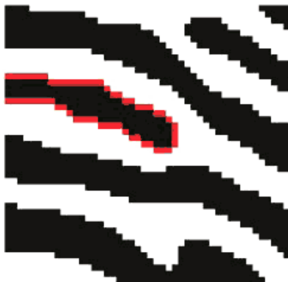
Рисунок F.12 — Граница окончания остова гребня
