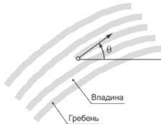
Рисунок 4 — Расположение контрольной точки окончания остова гребня
