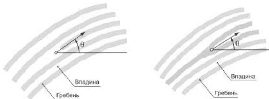
Рисунок F.16 — Направление контрольных точек окончания и бифуркации остова гребня, эквивалентно рисункам 2 и 3 из 6.4
