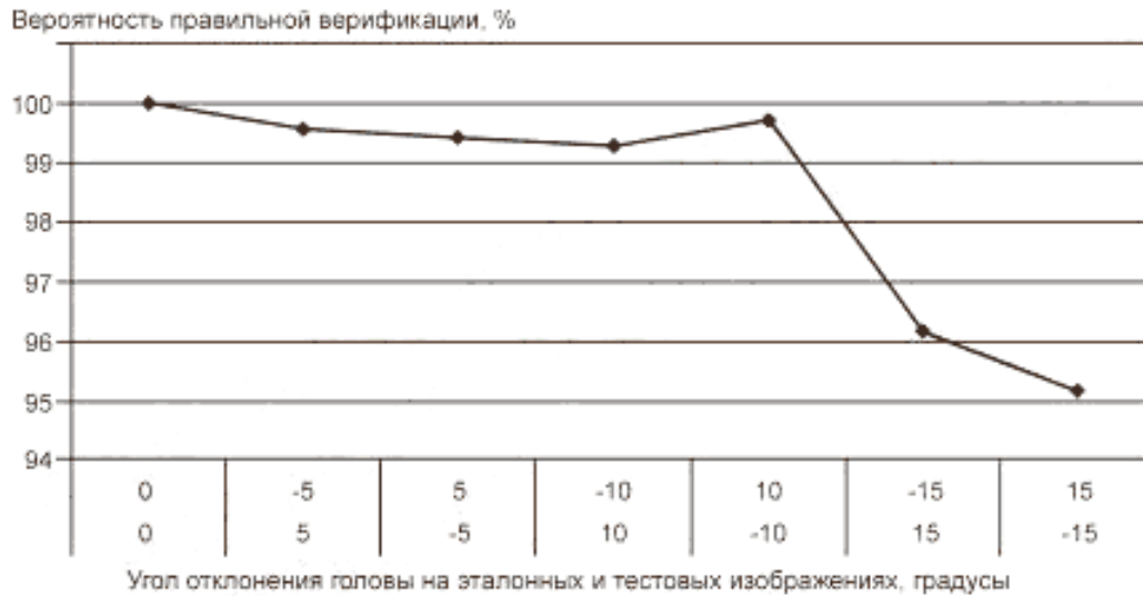
Рисунок D.8 — Зависимость вероятности правильной верификации от угла отклонения головы при вероятности ложного допуска 0,1 %
