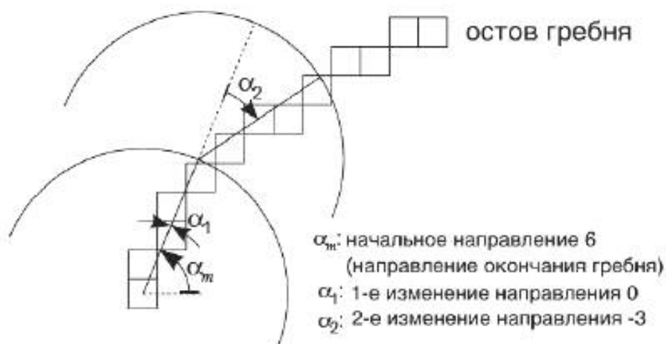
Рисунок 3 — Кодирование направления, начинающееся с точки окончания. Для записи изменения направления используется 4 бита
