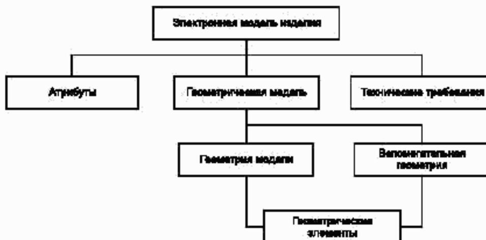
Рисунок Б.1 — Схема состава электронной модели изделия
