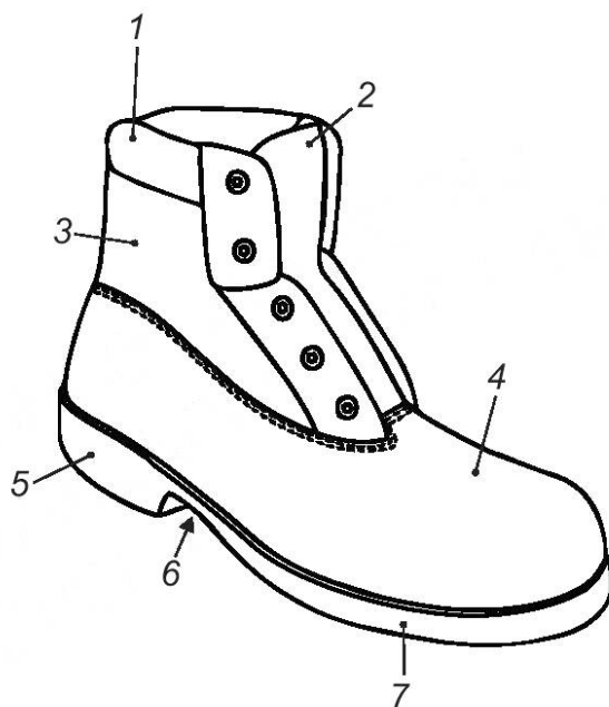
а) Пример комбинированной безопасной обуви в общем случае
