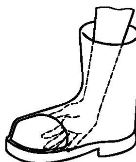
ф) Повреждение подкладки; острые края
