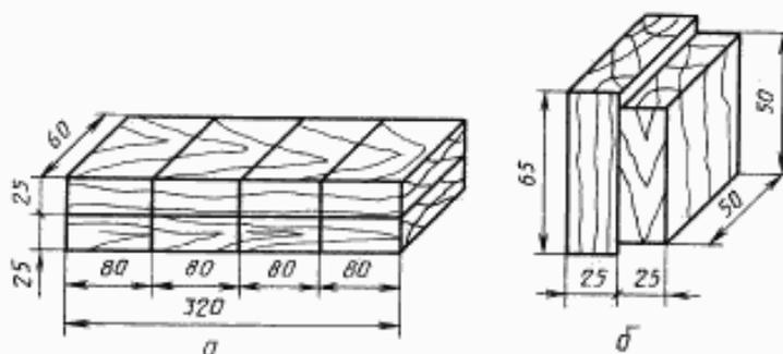
а — склеенные бруски; б — образец для испытания
