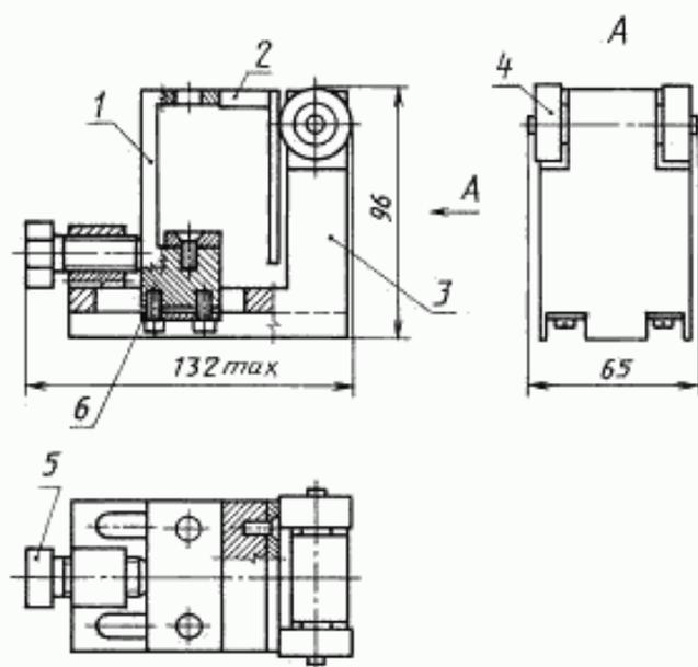
1 — ползун; 2 — прижим; 3 — корпус; 4 — ролик; 5 — регулировочный винт; 6 — шайба
