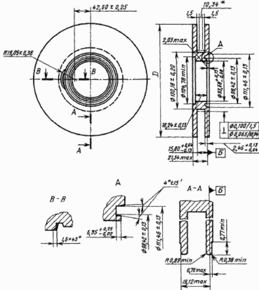
\* На длине 10,34 мм предельное отклонение диаметра должно быть  $\pm 0,13$  мм.
