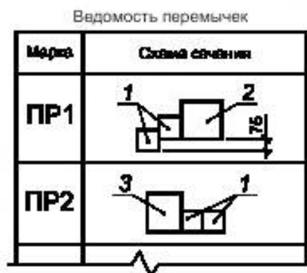
Рисунок В.1 — Пример выполнения ведомости перемычек
