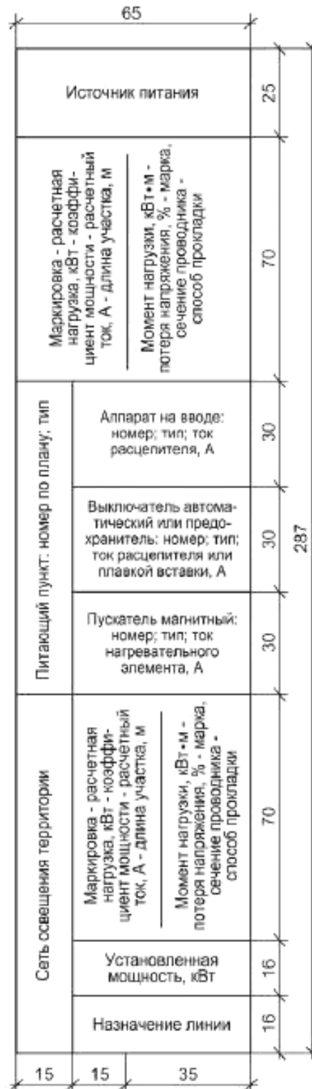
Форма 2 — Боковик принципиальной схемы питания освещения территории
