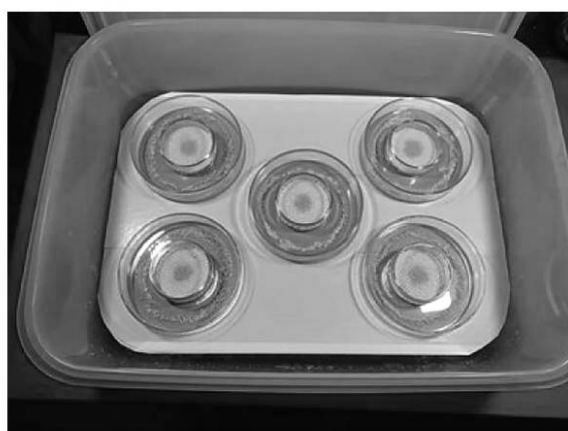
Рисунок С.3 — Герметичный контейнер для проведения испытания с чашками Петри
