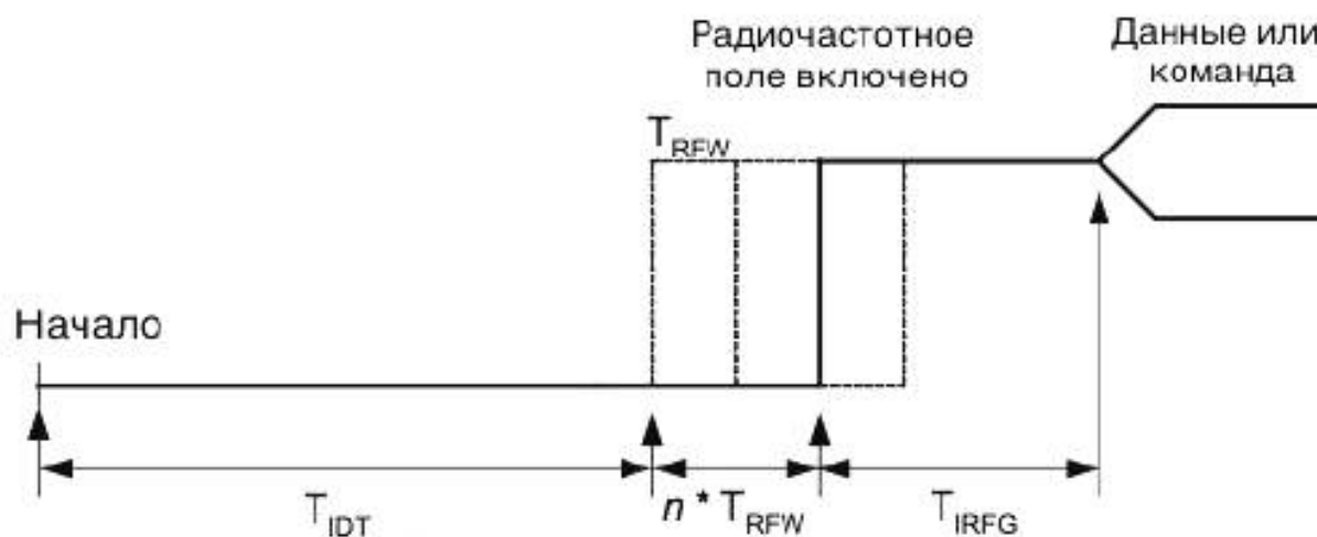
Рисунок 2 — Обнаружение радиочастотного излучения и первоначальная радиочастотная генерация для режима PCD и режима VCD
