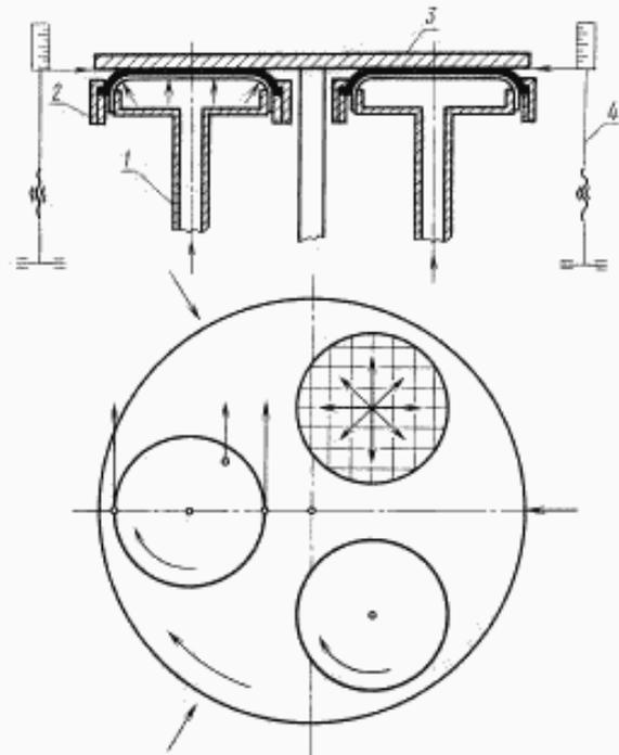
1 — головка прибора; 2 — обойма; 3 — истирающий диск; 4 — приспособление для установки зазора между абразивом и пробами
