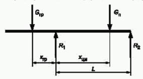
$G_{\rm rp}$  — масса груза;  $G_{\rm it}$  — масса погрузчика; L — база погрузчика;  $x_{\rm mid}$  — расстояние от центра массы погрузчика до передней оси;  $x_{\rm rp}$  — расстояние от центра массы груза до передней оси;  $R_{\rm it}$ ,  $R_{\rm it}$  — реакции от статических нагрузок соответственно на переднюю и заднюю оси погрузчика.
