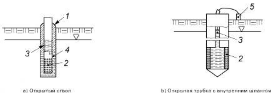
Рисунок 6 — Примеры открытых систем пьезометров
