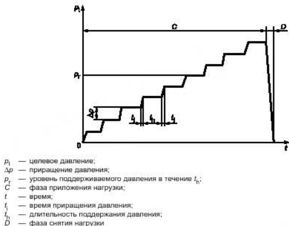
Рисунок 4 — Программа приложения нагрузки для прессиметрического испытания по Менарду
