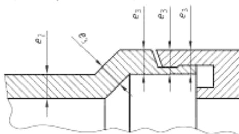
Рисунок 4 – Толщина стенки раstra с крышкой для установки уплотнительного кольца
