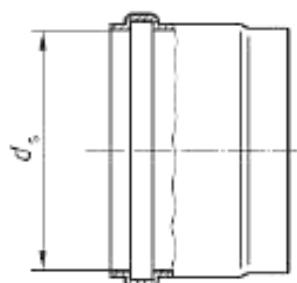
Рисунок 11 – Патрубок для стыковой сварки
