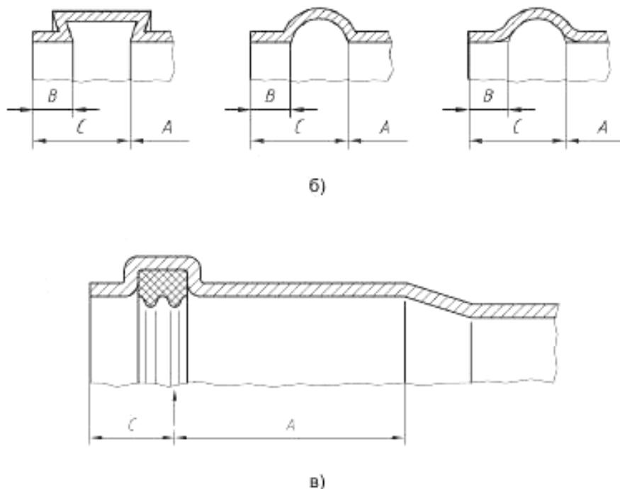
$d_s$  – внутренний диаметр раструба;  $A$  – минимальная длина контакта;  $B$  – длина входа;  $C$  – глубина точки эффективного уплотнения;  $L_1$  – длина трубного конца;  $e_2$  – толщина стенки раструба;  $e_3$  – толщина стенки в зоне канавки под уплотнительное кольцо
