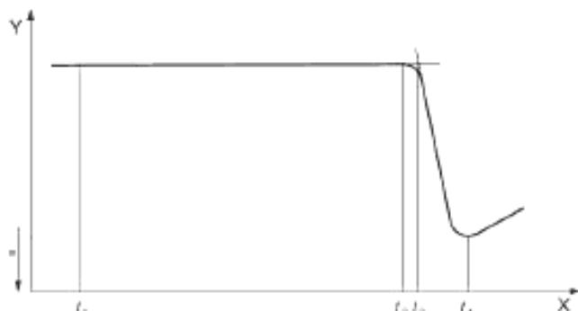
X – время; Y – тепловой поток; а – максимум экзотермы;  $t_1$  – переключение на кислород или воздух (время ноль);  $t_2$  – начало окисления;  $t_3$  – точка определенная методом касательной;  $t_4$  – максимум окисления
