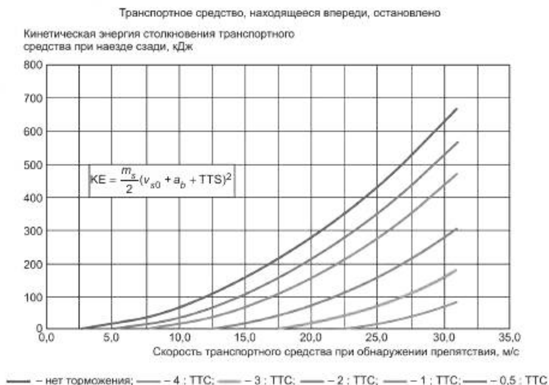
Рисунок А.1 — Энергия при столкновении, среднее замедление при торможении 0,5 g
