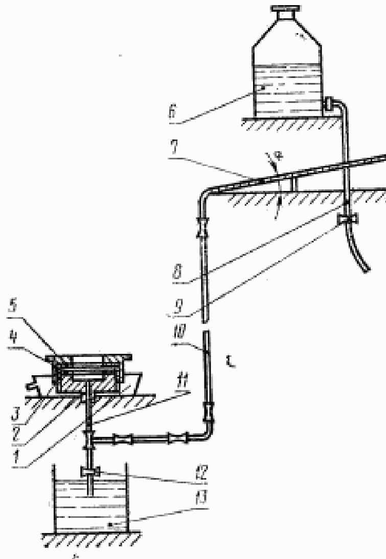
1—ванна; 2—полная камера; 3—крышка; 4—резиновая уплотняющая прокладка; 5—металлическая прокладка; 6—сосуд с тубусом для воды; 7—стеклянная градуированная трубка; 8, 10—резиновые трубки; 9, 12—зажимы на трубках; 10—стеклянная трубка; 13—бачок для синей воды
