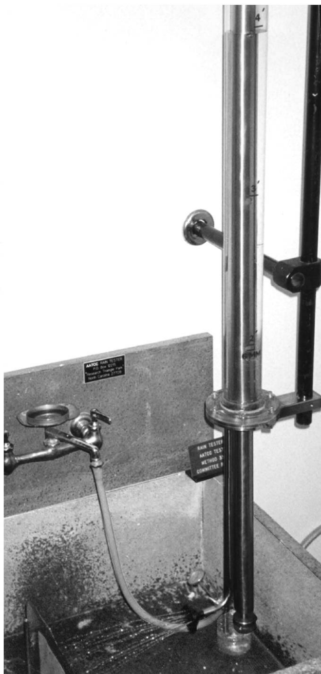
Рисунок 1 — Устройство для испытания методом дождевания, полная сборка
