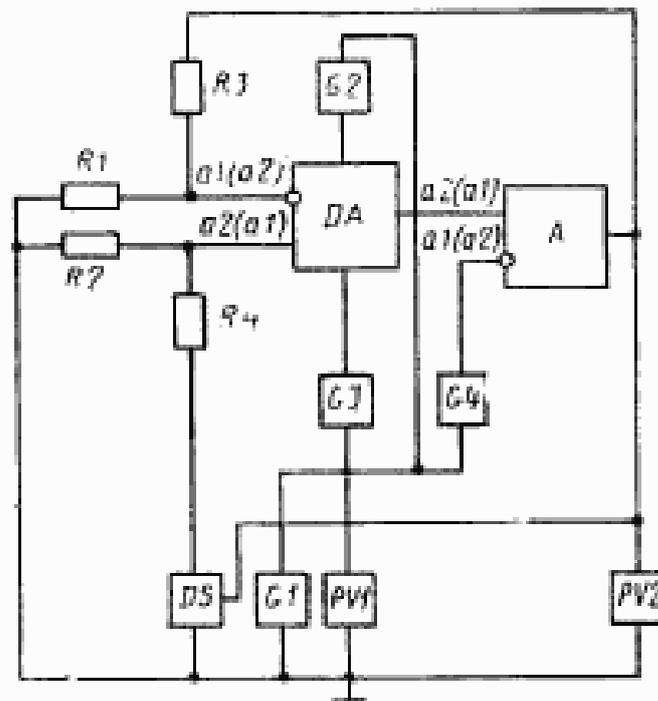
DA — проверяемый ОУ или КН; А — вспомогательное устройство балансировки;  $G_1, G_2, G_3, G_4$  — источники постоянного напряжения; DS — устройство выборки и хранения; PV1, PV2 — измерители постоянного напряжения;  $R_1, R_2, R_3, R_4$  — резисторы делителей напряжения;  $a_1$  — инвертирующий вход;  $a_2$  — неинвертирующий вход
