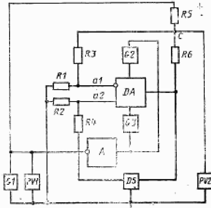
DA — проверенный ОУ или КН;  $G1$ ,  $G2$ ,  $G3$  — источники постоянного напряжения; DS — устройство выборки и хранения; PV1, PV2 — измерители постоянного напряжения;  $R5$ ,  $R6$  — резисторы суммирования;  $R1$ ,  $R2$ ,  $R3$ ,  $R4$  — резисторы делителей напряжения; A — усилитель-инвертор;  $a1$  — инвертирующий вход ОУ или КН;  $a2$  — неинвертирующий вход ОУ или КН; C — суммирующая точка
