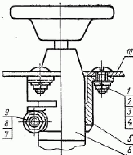
1—гайт М5 по ГОСТ 17473—80; 2—гайка М5 по ГОСТ 13958—74; 3—шайба 5 по ГОСТ 10450—78; 4—пружинная шайба 5Т по ГОСТ 6402—70; 5—кронштейн; 6—вентиль; 7—болт М6 по ГОСТ 7798—70; 8—гайка М6 по ГОСТ 13958—74; 9—шайба 6 по ГОСТ 10450—88; 10—стенка панели.
