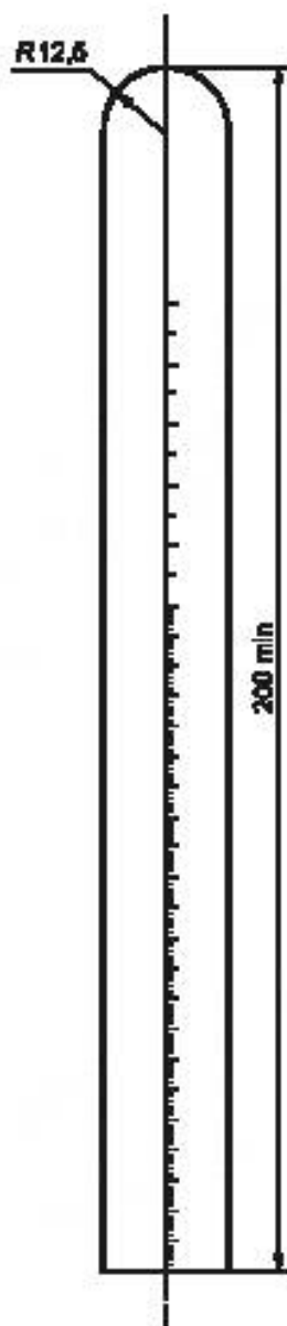
Рисунок D.1 — Градуированный стержень для определения длины презерватива
