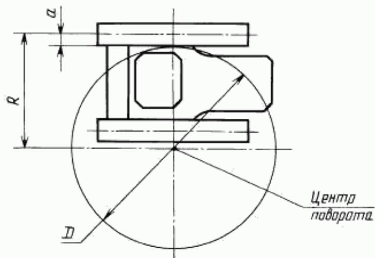
$D$  — диаметр окружности поворота;  $a$  — половина ширины гусеницы;
