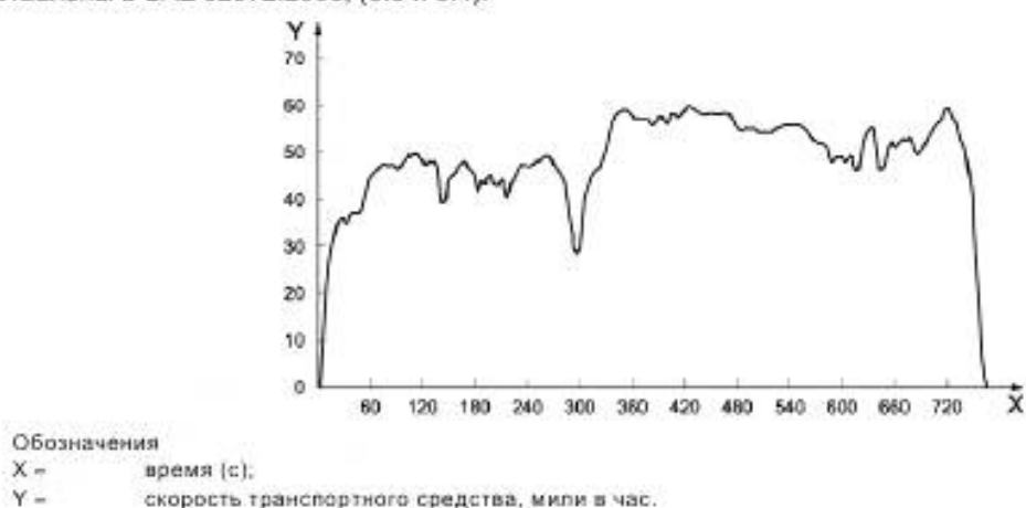
Рисунок С.2 — Последовательность испытаний транспортного средства, имитирующих загородное движение в условиях США, в соответствии с загородным экономичным циклом движения (HFEDS)
