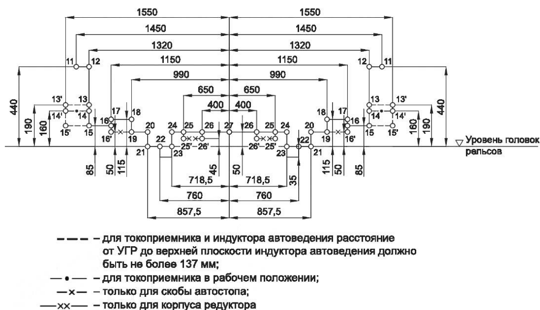
Рисунок 11 — Габарит М. Нижнее очертание габарита М
