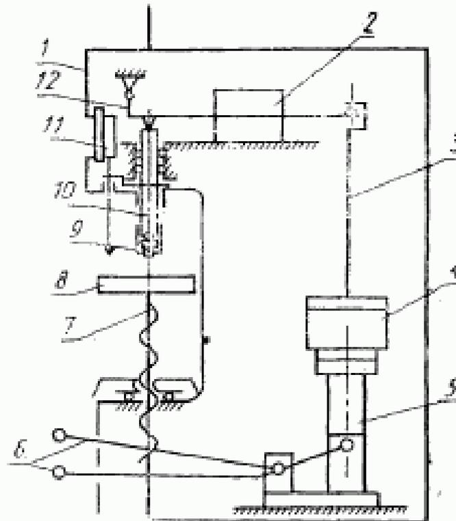
1 — корпус; 2 — блок управления сигнализацией; 3 — подвеска; 4 — грузы; 5 — демпфер; 6 — рукоятка управления; 7 — винт; 8 — стол; 9 — индентор; 10 — шток; 11 — индикатор; 12 — рычажная система
