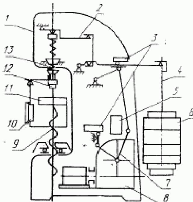
1 — корпус; 2 — рычажная система; 3 — микропереключатель; 4 — подвеска; 5 — блок управления; 6 — сменные грузы; 7 — рычаги привода; 8 — редуктор; 9 — винт; 10 — индикатор; 11 — стол; 12 — индикатор; 13 — пружина предварительной нагрузки.
