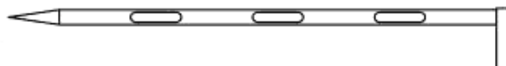
Рисунок В.9 — Концентрический пробоотборник для мешков типа «трости»: открытая ручка с одним или несколькими отверстиями
