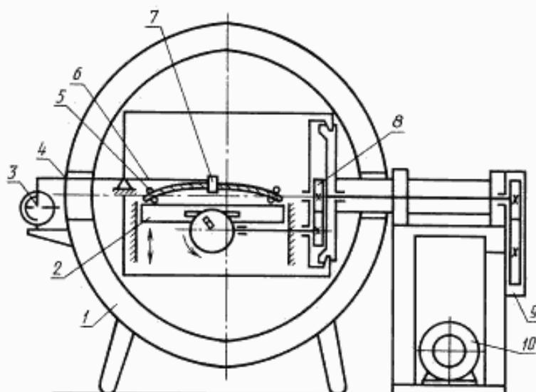
1 — термоклав; 2 — кривошипно-кулисный механизм; 3 — динамометр; 4 — рычаг силоизмерителя; 5 — опора;
